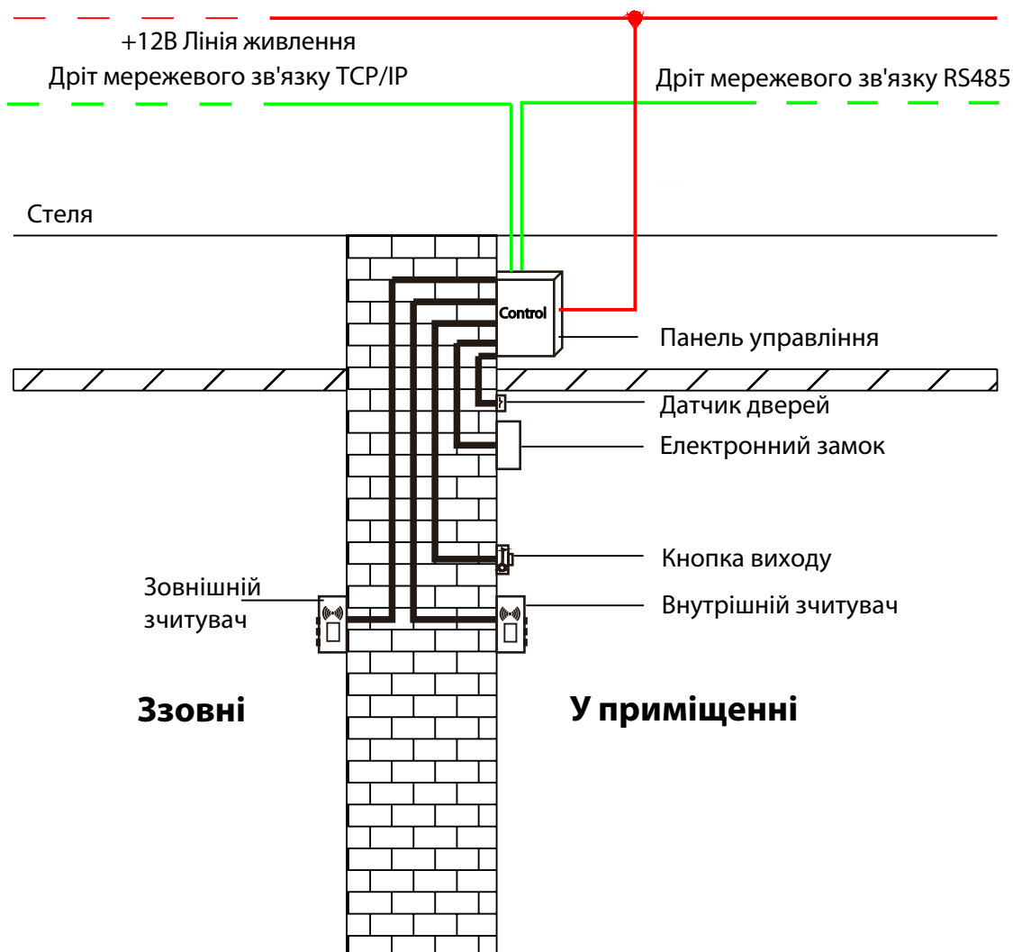
Схема монтажу проводів панелі управління доступом
